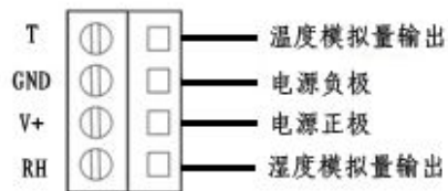
0-5V输出电气接线图
