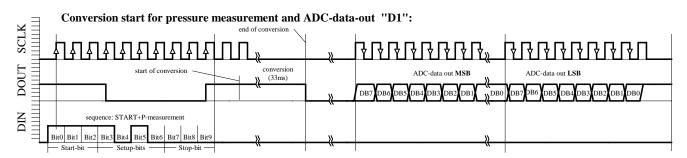
Fig. 6a: D1 ACQUISITION sequence
