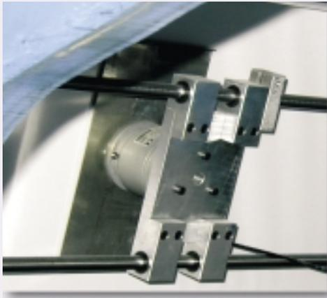
BFC 平板探头适用于测量移动物体的平衡相对湿度，如纸张、卡片、纺织物等。当速度适当时可以直接与被测物体接触测量；当被测物体移动速度太高或是表面不光滑时，要注意周围环境的温度变化及气流冲击造成影响，尽量使被测物间距为 0.5 到 1mm，这样就可以最大限度地减少测量误差。
