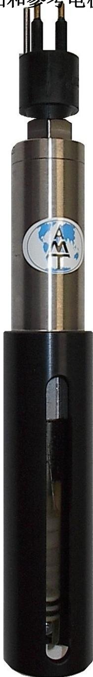
已经开发了具有集成电子设备的 ORP 组合浅水传感器，用于与现有的 CTD 探针系统接口。传感器由塑料棒中的压力平衡铂电极和参比电极（Ag / AgCl）组成。它配有一个含有大量毛孔的陶瓷隔膜。电解质是不含银离子的含 KCl 的凝胶，以允许在含 H<sub>2</sub>S 和硫化物的样品中进行测量。ORP 浅水传感器配有钛壳，包括电子设备，塑料保护笼和 BH 4 M SUBCONN 钛连接器。自行风险，保护笼可能被拧下来。传感器必须由客户自己进行校准（根据要求进行校准）。所有电极都带有含有 pH 4 缓冲液/ KCl 的润湿帽，并覆盖测量端。
