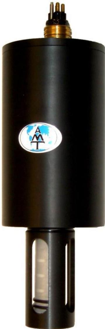
AMT公司已与梅克伦堡/福尔波门州农业和水产养殖业研究中心、渔业协会(德国)共同研发出一种覆膜光学传感器,用于测量浅水中的CO<sub>2</sub>含量。
