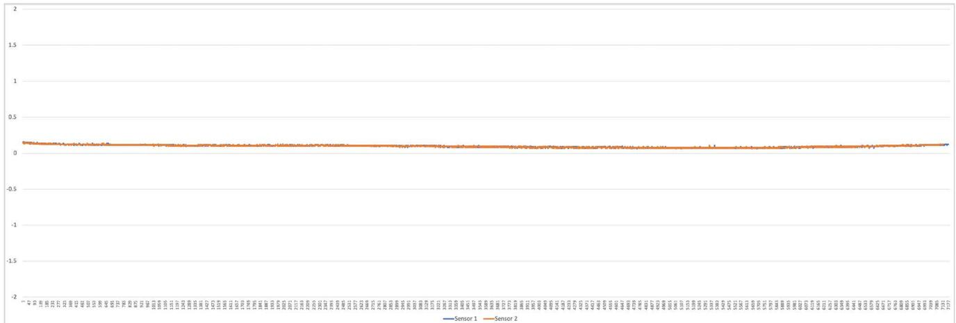
典型测试结果显示：12小时洁净空气测试，零点漂移 <0.3ppm(0-2ppm 为正常零点波动范围)；
